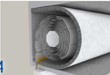
4 Inserire i pannelli isolanti. L'isolamento richiede una battuta all'architrave e al di sopra dell'infisso (es.: montare un angolare).
