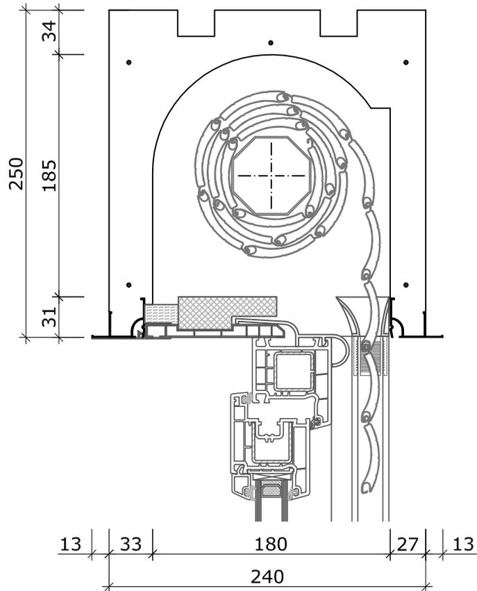
\* 31 mm Verschlussdeckel mit Neopordämmung
