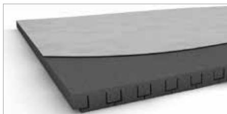
Ideale per la ristrutturazione di cassonetti per avvolgibili non isolati, con apertura sul lato locale, verso il basso o verso l'interno. Costituito da un pannello scanalato di Neopor® [ $\lambda = 0,032 \text{ W/(mK)}$  – BI (difficilmente infiammabile)] con barriera vapore all'esterno. Si può tagliare facilmente a misura con un taglierino. Il nuovo segmento a T assicura valori di isolamento ottimali.
