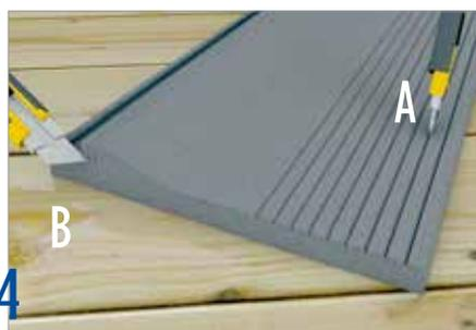
4 Grazie ai punti di taglio predefiniti, tagliare la base rigida per il pianale del cassonetto in funzione della larghezza necessaria (A) e dello spessore di isolamento di ROKA-THERMO-FLEX NEOLINE (B).
